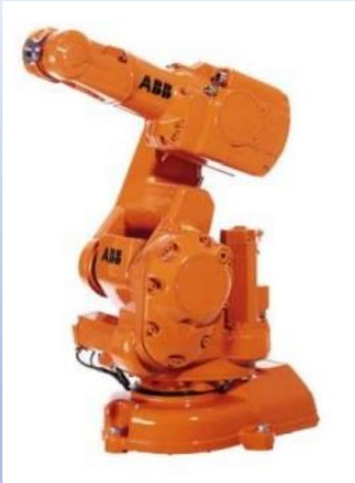
“Um robô industrial é uma máquina manipuladora, com vários graus de liberdade, controlada automaticamente, reprogramável, multifuncional, que pode ter a base fixa ou móvel, para utilização em aplicações de automação industrial”
